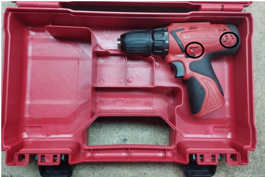
Obr.1 Stav náradia pri príjme (znečistené ventilačné otvory)
