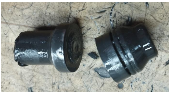
Obr.2 Uvoľnený predný kryt valca
