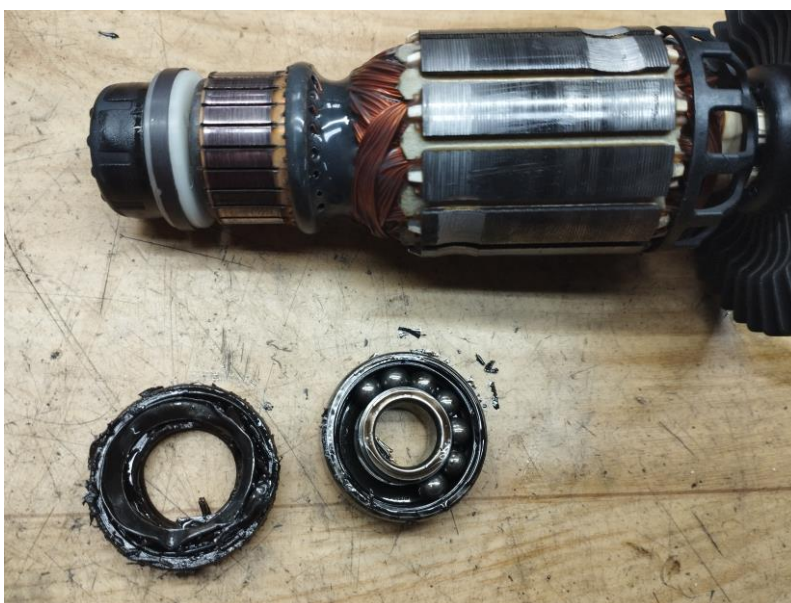
Obr.3 Poškodenie ložiska rotora
