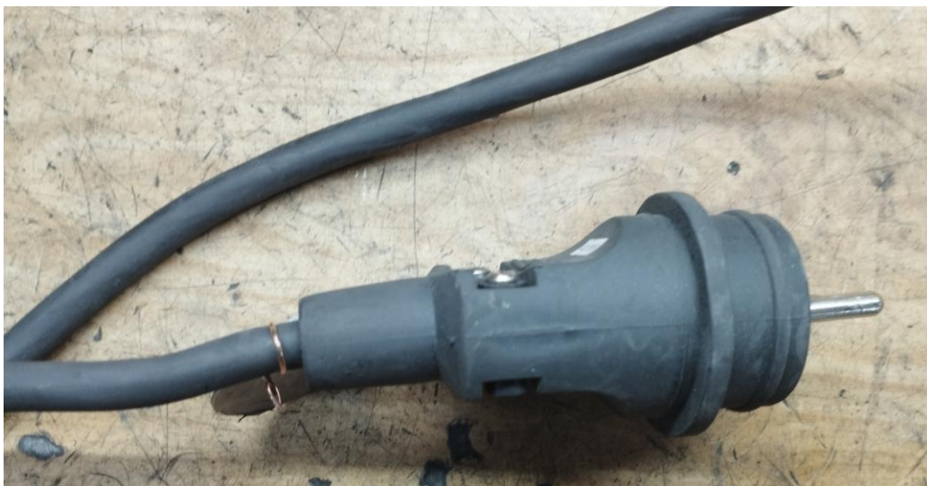
Obr.2 Použitie nevhodnej vidlice prívodného kábla
