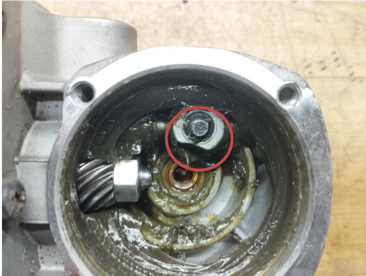
Obr.1 Poškodenie aretačného kolíka
