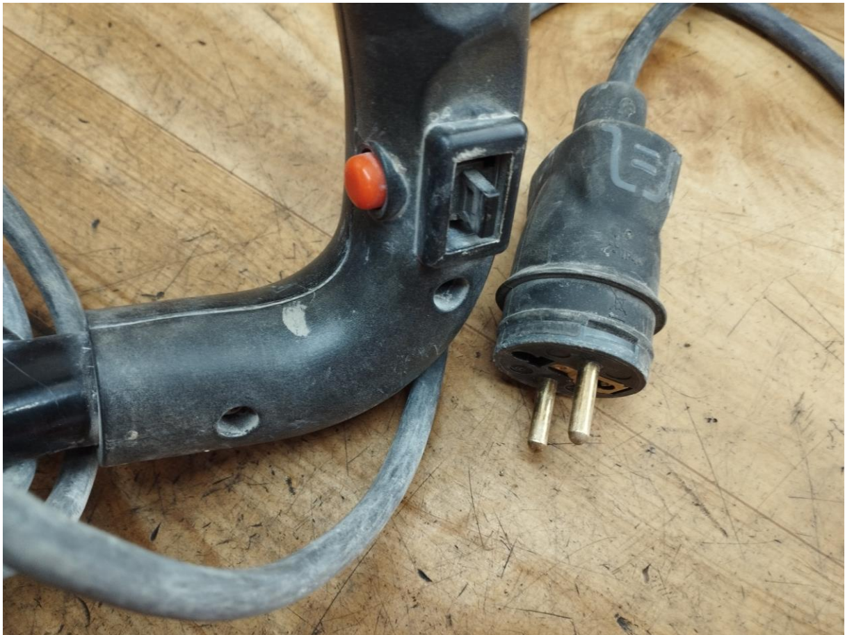
Obr.1 Poškodenie spínača, nevhodný kábel
