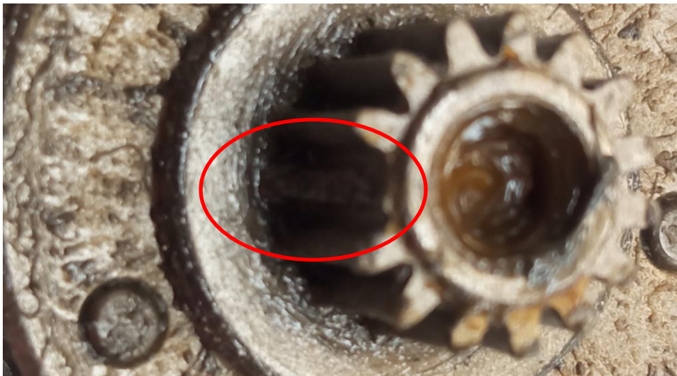
Obr.2 Chýbajúci zub na ozubenom prevode
